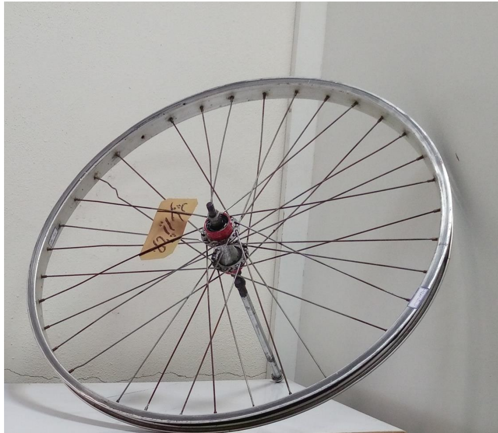
شکل ۳: چرخ ژيروسکوپي (وسیله کمک آموزشی جهت نمایش کوپل ژيروسکوپي)
